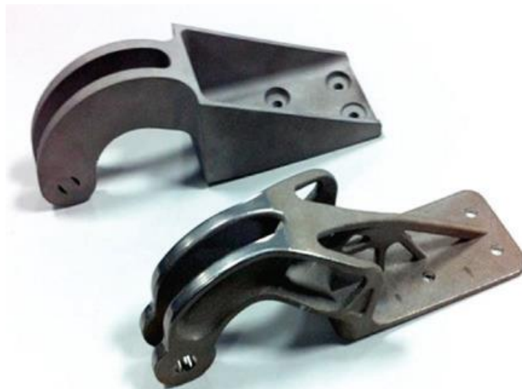
Repülőgépben használt teherhordó alkatrész a topológiai optimalizálás előtt (fent) és után (lent)
