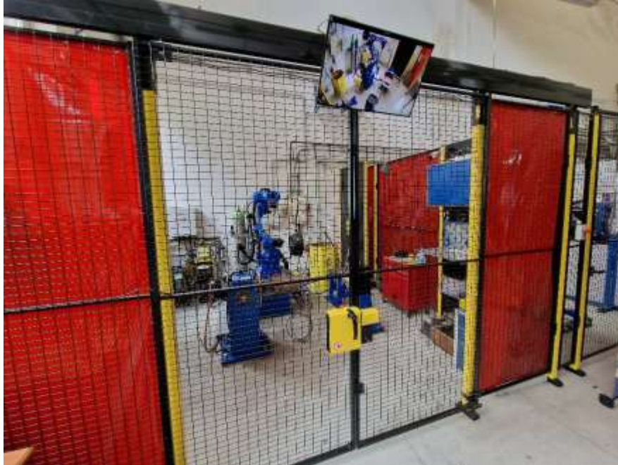
Hegesztőrobotot elszigetelő biztonsági cella
