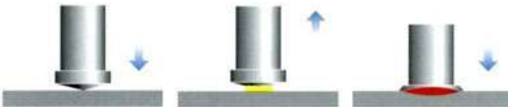
Az ívhúzásos csaphegesztési eljárás működési elve
