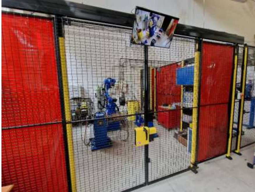
Hegesztőrobotot elszigetelő biztonsági cella
