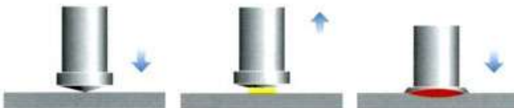
Az ívhúzásos csaphegesztési eljárás működési elve
