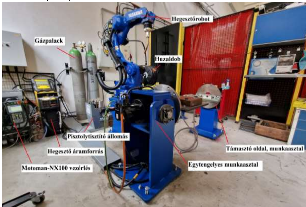
A robotcella felépítése
