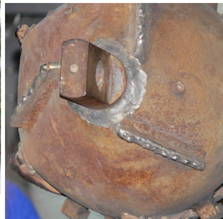
Kopott talajfúrófej vágóélei javítva
