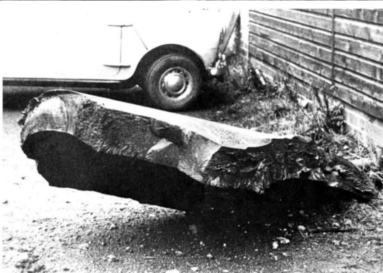
Az előző ábrán látható tartály egy 2 tonna tömegű, 46 m-re repült darabja
