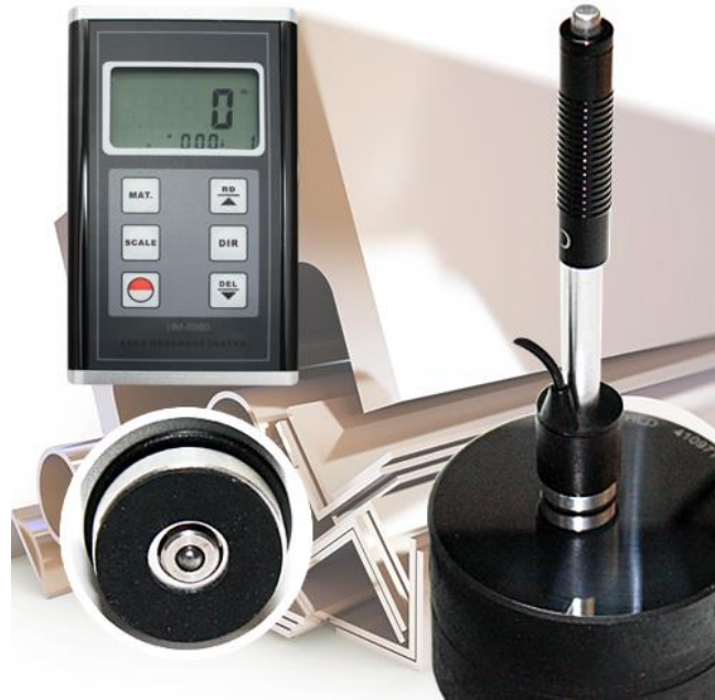
10. ábra Napjainkban használt szklerszkóp digitális kivitelben
