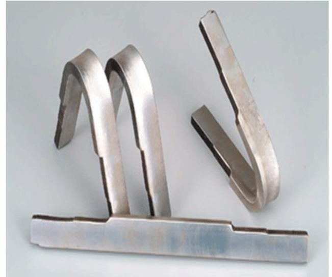
Das Biegen ist bis zum Risserscheinen durchgeführt, und der  $\alpha$  Biegewinkel ist zu messen.
